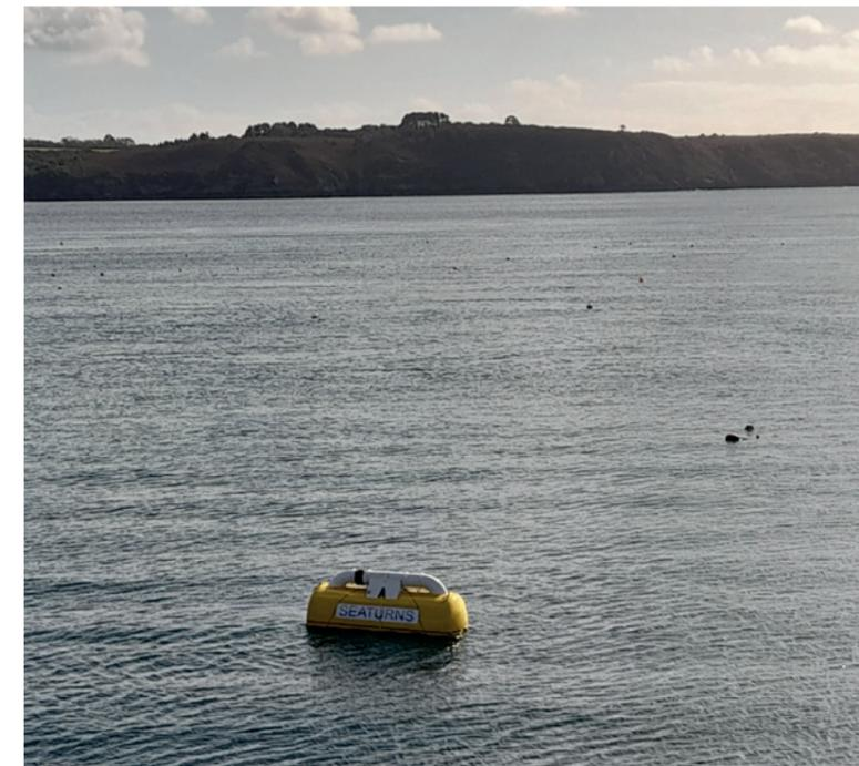
l'énergie de la houle via le concept de pendule d'eau. Les essais en mer avec notamment des optimisations sur les lignes d'ancrage vont durer une année.
